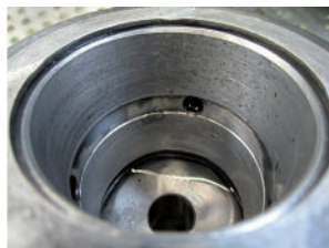
Glijlager krukas zwaar beschadigd door versmering
