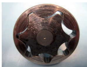
Binnenwerk oliepompe beschadigd door versmering
